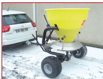
ECT 400 PVC tracté par une voiture
